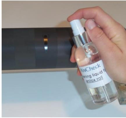
Nettoyer le FerroFluide sur le cylindre avec le papier absorbant et le liquide de nettoyage AniCheck
