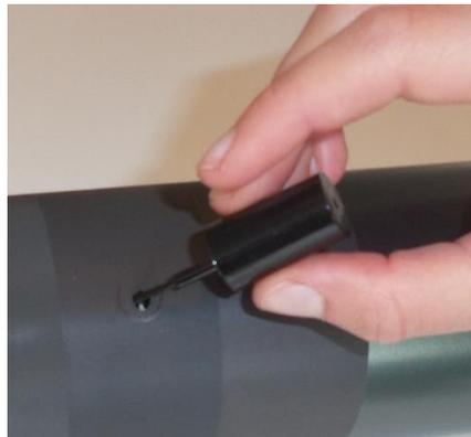
Appliquer le FerroFluide sur la surface du cylindre sur une ligne d'environ 1 cm de longueur.
